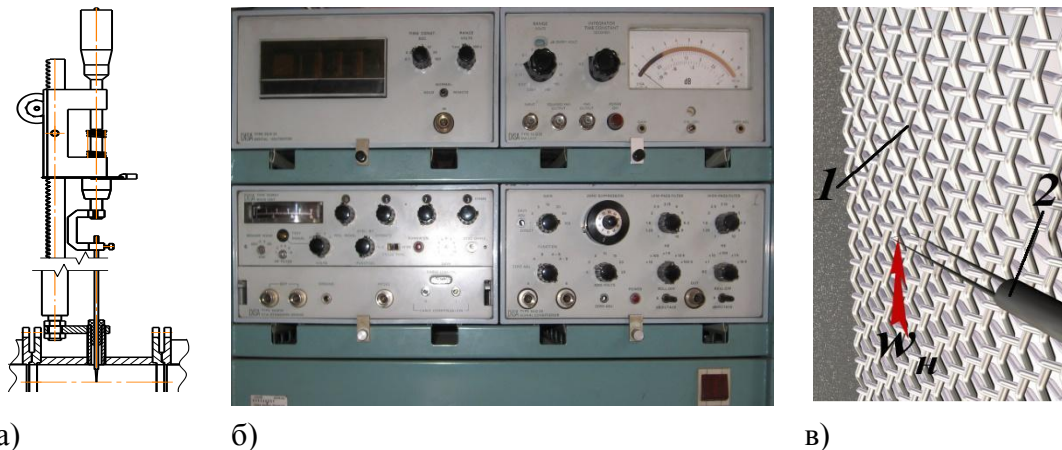
Рис. 1 Робоча ділянка аеродинамічної труби (а), термоанемометрична система DISA 55M (б) та елемент сітчастої поверхні (в): 1 – сітчасте покриття; 1 – датчик
