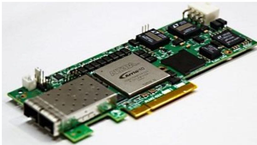
FPGA-прискорювач з ІМС FPGA Intel Altera Arria 10 і портами 2x10GE
