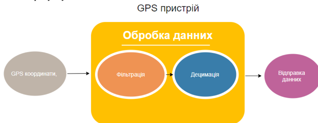
Рис. 1. Схема обробки та передачі gps координат
