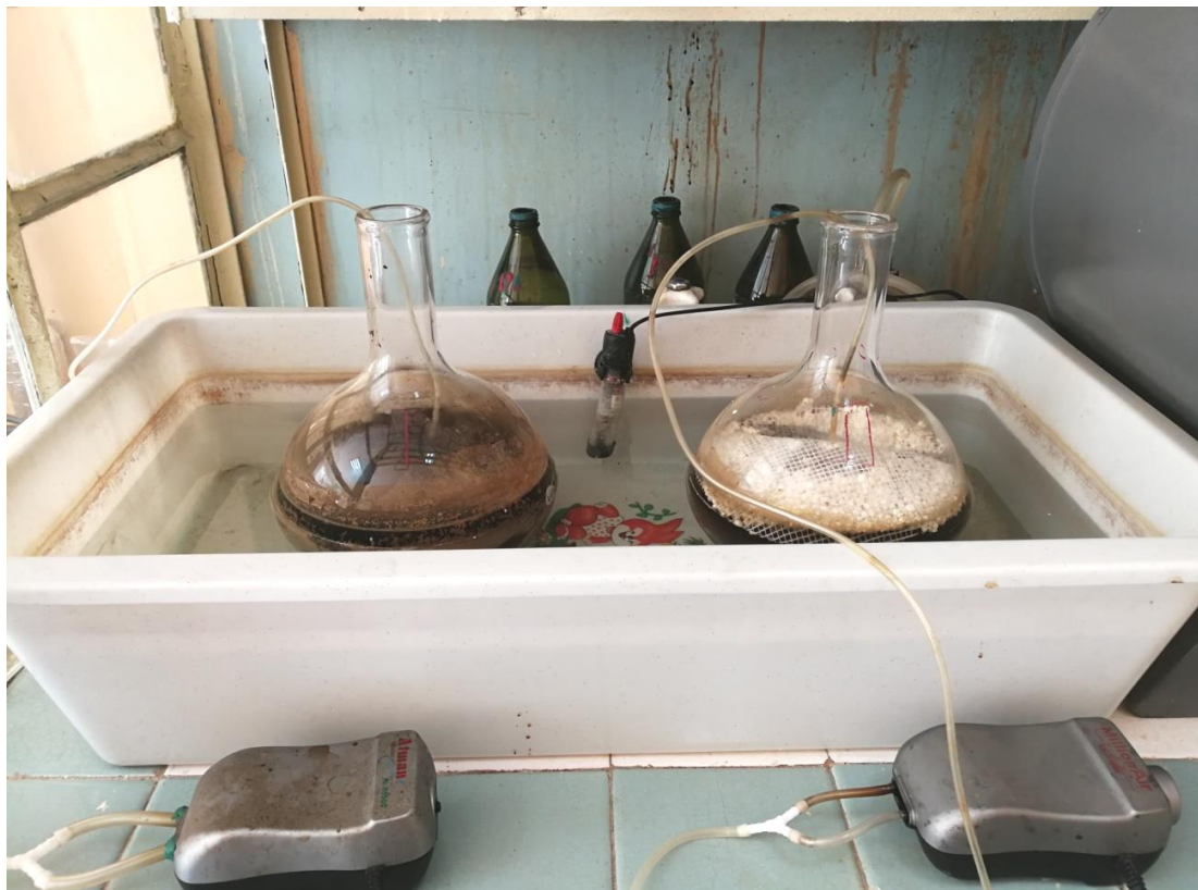
Рисунок 2. Загальний вигляд дослідної установки дослідження залежності ефективності очищення інфільтрату від внесення в систему насадкових тіл для іммобілізації на них біоценозу
