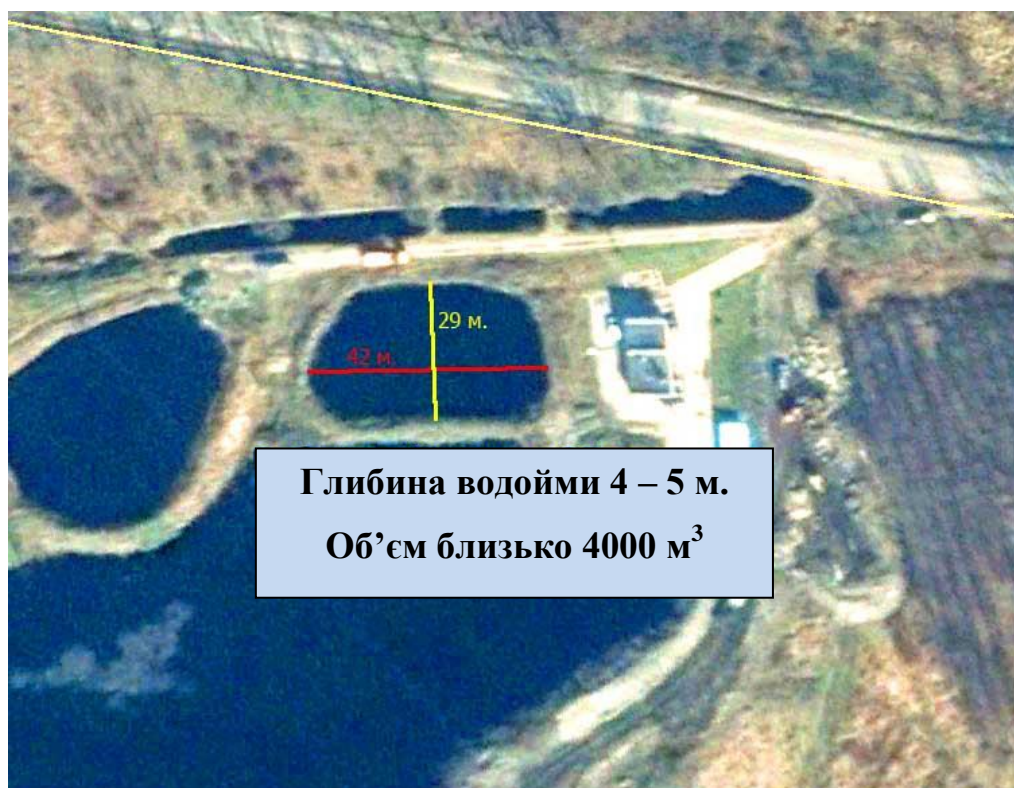
Рисунок 6. Пропозиція щодо влаштування аеробної лагуни на Львівському сміттєзвалищі
