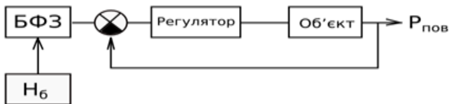
Рис. Структурна схема АСР тиску повітря на аерацію АПЖ.
